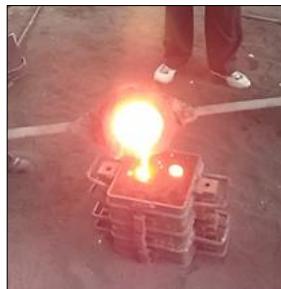
Fig. 4: Pouring of molten metal
