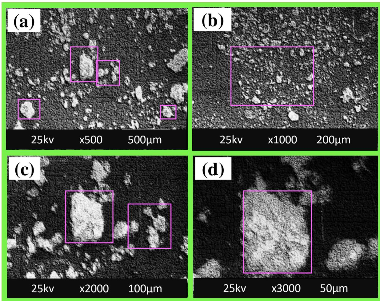
**Fig. 4.** SEM images of Ni-CuC nanocomposite at (a) 500 $\times$  (b) 1000 $\times$ , (c) 2000 $\times$  and (d) 3000 $\times$ .
