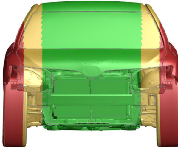
Figure 41. Transverse CofG Parameter Zones (YZ)
